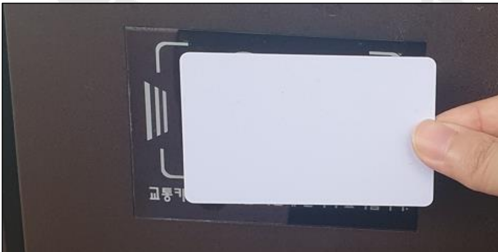
그림 81. 복제 카드를 이용하여 교통카드 잔액 확인
